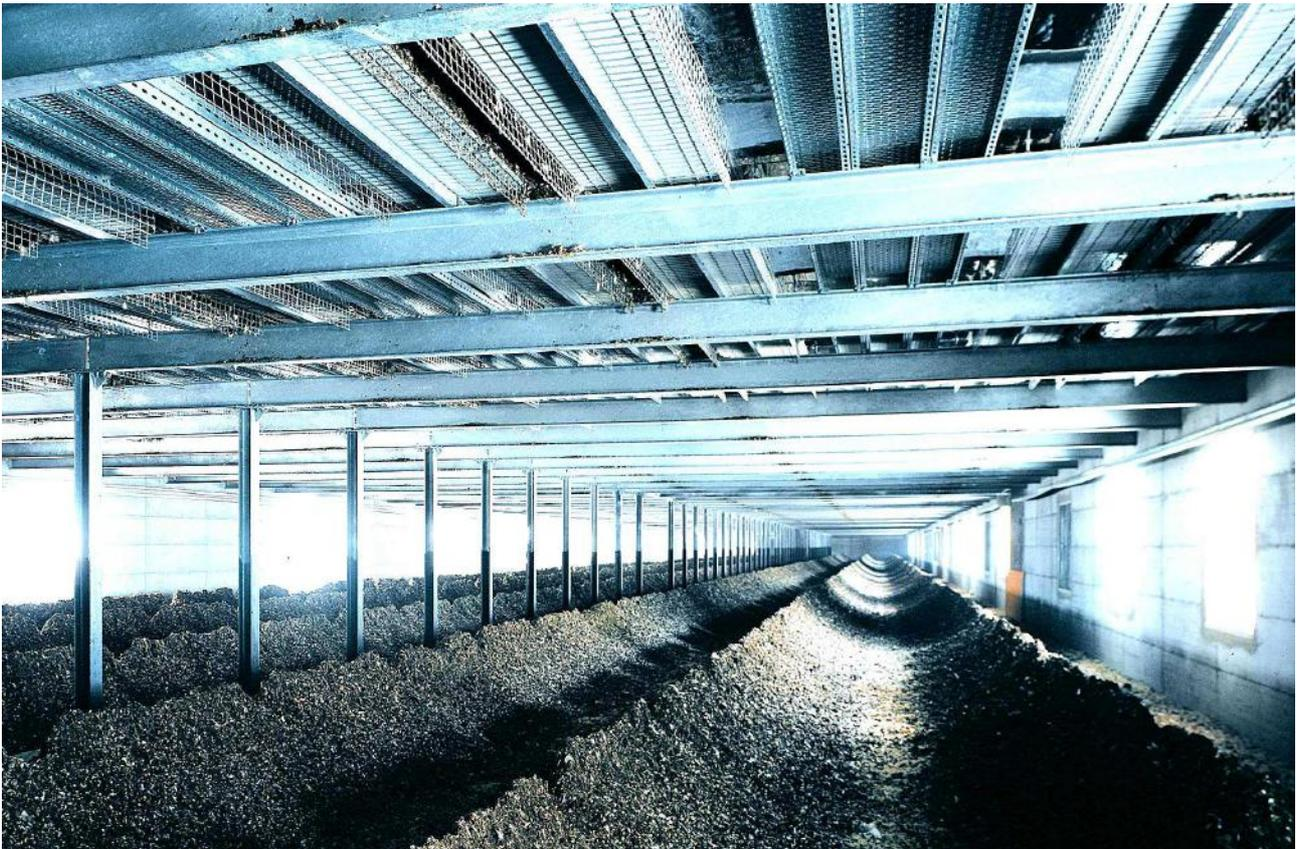
En los pisos intermedios están colocados unos rascadores en acero inox que hacen caer la gallinaza al silo inferior de la nave desde donde se retira con el tradicional rascador en fosa. La forma de los rascadores intermedios y el sistema de guía entre los cestones son patente TECNO POULTRY EQUIPMENT.
